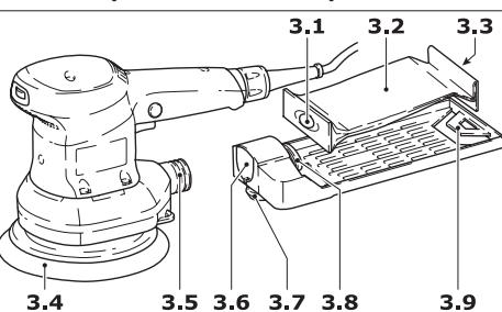
Las máquinas están equipadas como equipo de serie con un dispositivo autoaspirador. El polvo de lijado es aspirado por las aberturas de aspiración que se encuentran en el plato de lijado (3.4) y es recogido en el turbofiltro (3.2). Cuando el turbofiltro se ha llenado hasta el punto de que se nota una merma de la capacidad de aspiración, se deberá proceder a su cambio.
